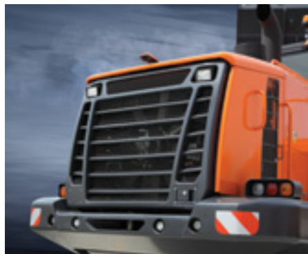
Решетка радиатора (Стальная конструкция)
